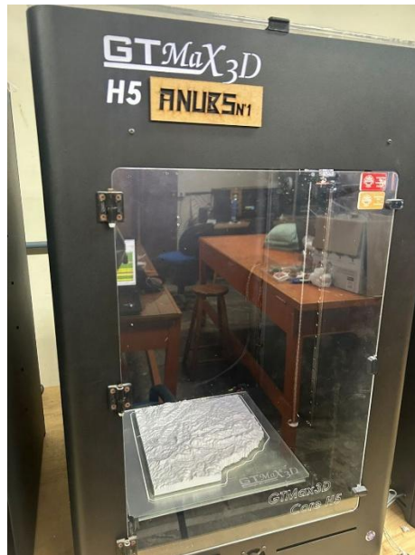
Figura 1 - Impressora 3D (Maquetaria FAURB – Faculdade de Arquitetura e Urbanismo da UFPEL) finalizando a impressão de uma peça que compõe a maquete tridimensional da Amazônia.
