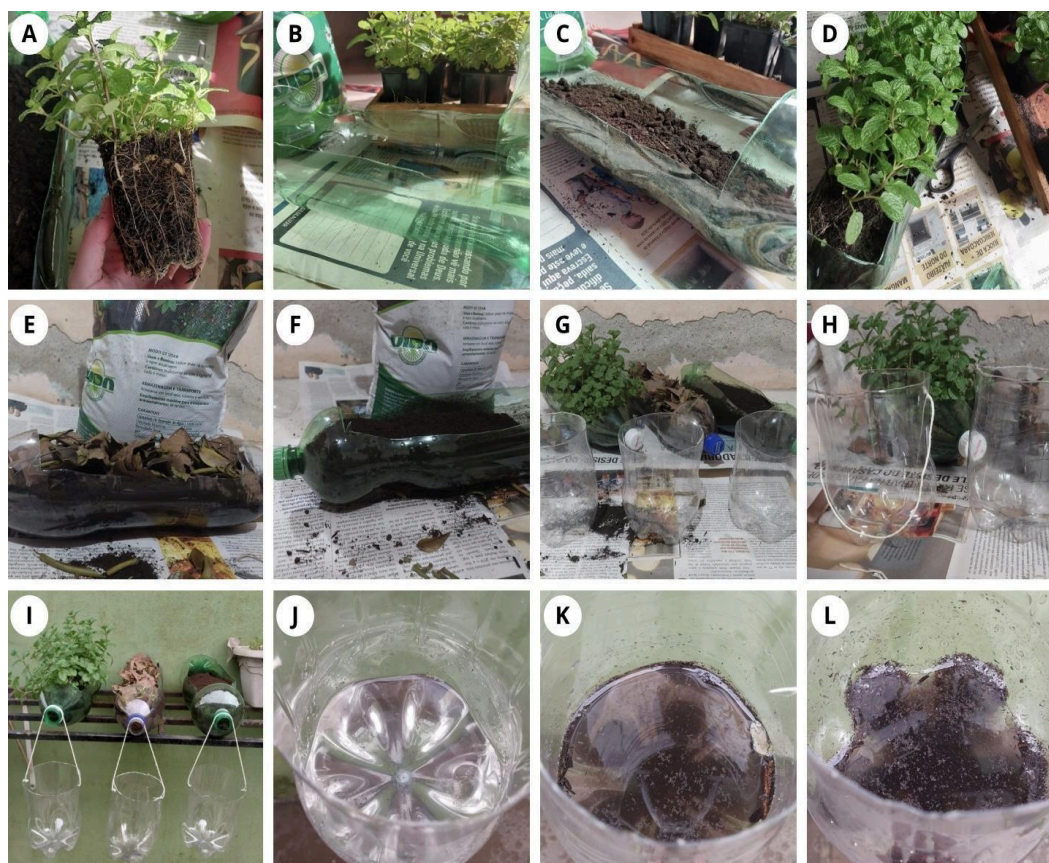
Figura 1 - A) muda de hortelã; B) demonstração dos cortes verticais realizados em três garrafas; C) garrafa com fundo coberto de terra preta; D) garrafa com a simulação da mata ciliar; E) garrafa com a simulação da serrapilheira; F) garrafa apenas com a terra preta simulando um ambiente perturbado; G) e H) cortes feitos em três garrafas que servirão como coletores da água; I) montagem final do experimento; J) água coletada após a aplicação na garrafa com as mudas de hortelã; K) água coletada após a aplicação na garrafa contendo serrapilheira; L) água coletada após a aplicação na garrafa contendo apenas terra preta.
