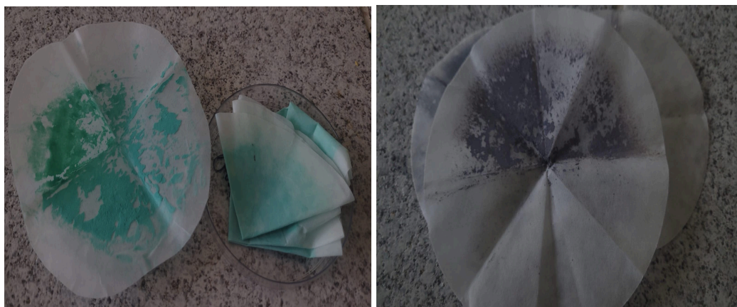
Figura 1a: filtrado contendo hidróxido de cobre \text{Cu(OH)}_2 . Figura 1b: filtrado contendo cloreto de prata \text{AgCl} .
