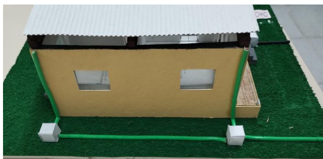
Figura 3: Representação do sistema pluvial na maquete física.
