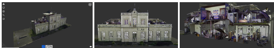
Figura 3: Nuvem de pontos no Autodesk Recap (a) fachada diagonal (b) fachada frontal (c) ambientes internos
