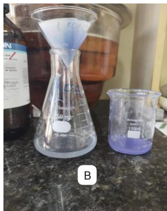
Figura B: Becker, Funil, Filtro, Erlenmeyer, Água filtrada transparente, Água com azul de toluidina e carvão mineral ativado.
