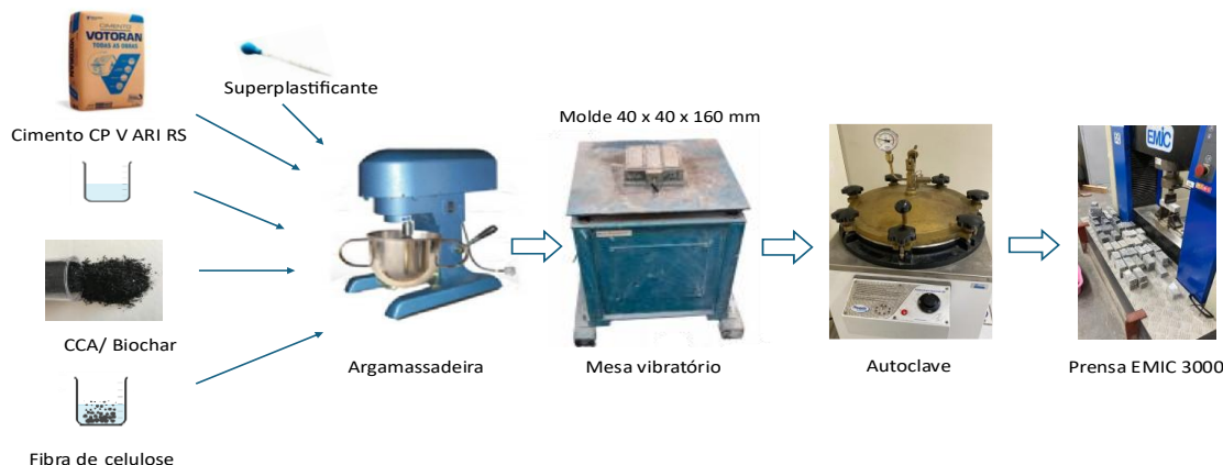
Figura 1 - Processo de preparação do fibrocimento.
