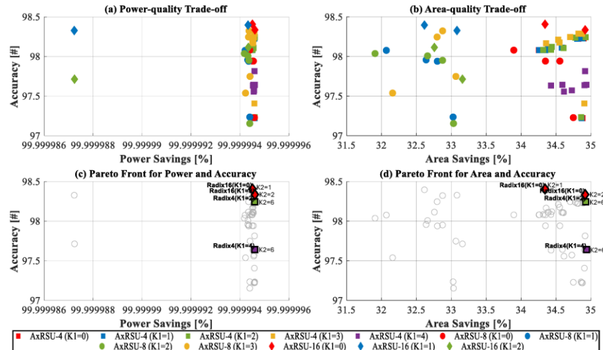
Figura 2 - Fronteira de Pareto: Equilíbrio entre acurácia, área e potência nas diferentes configurações do AxRSU-2 m .
