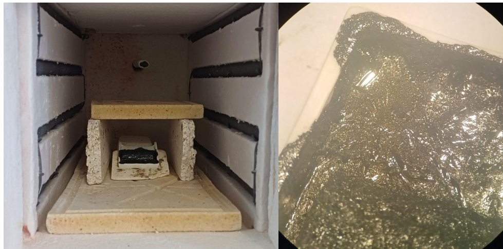
Figura 2: monocristais obtidos a partir do emprego da técnica de auto-fluxo, (a) arranjo empregado para o crescimento, (b) monocristais obtidos após a etapa de crescimento.
