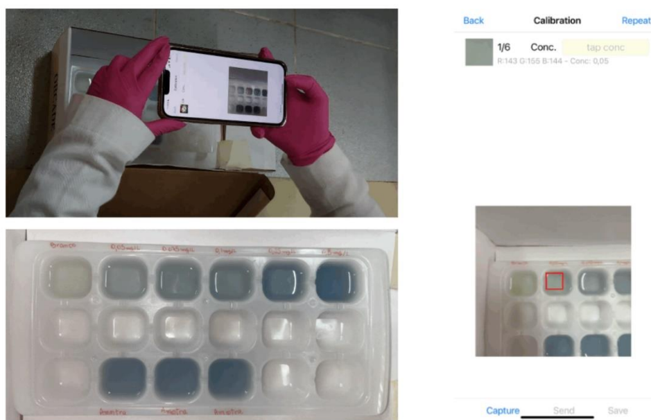
Figura 2. Imagens obtidas durante o procedimento de captura fotográfica com o aplicativo PhotoMetrix®, mostrando as soluções da curva de calibração e as amostras dispostas em forma de gelo.
