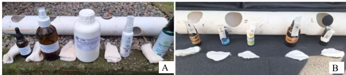
Figura 2 - Cano PVC com orifícios onde eram aplicados hidrolatos (A) e óleos essenciais (B).
