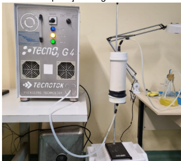
Figura 1: Ozonizador da marca Tecnotok em funcionamento, utilizado para aplicação do gás.
