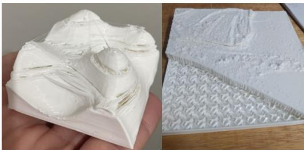
Figura 3 - Fotografias de erros comuns nas impressões 3D durante a produção do mapa. Fonte: Autores.
