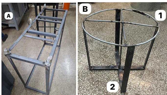
Figura 3 - Em (a) tem a montagem da estrutura da base do silo armazenador. Em (b) está o suporte das peneiras; (1) suporte da peneira; (2) suporte da barra roscada
