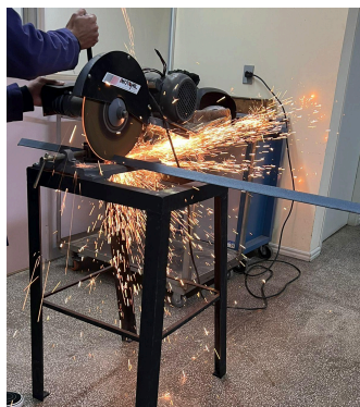
Figura 2 - Realização de cortes nas barras de cantoneiras e nas chapas metálicas
