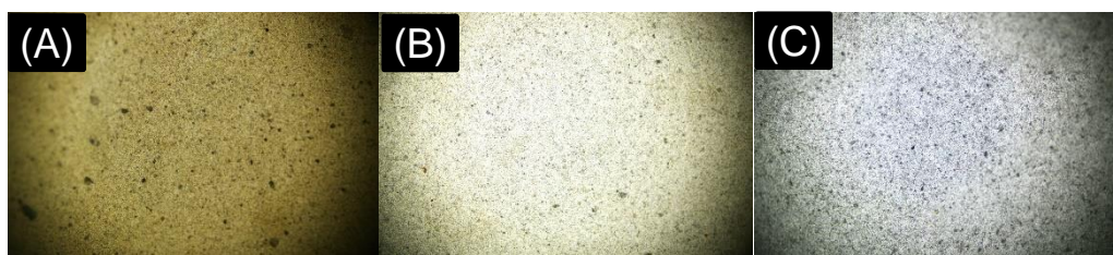
Figura 1: Microscopia óptica das amostras de arundo dos filmes lignocelulósicos de arundo de diferentes pré-tratamentos (A) ácido sulfúrico; (B) hidróxido de sódio; (C) branqueamento.
