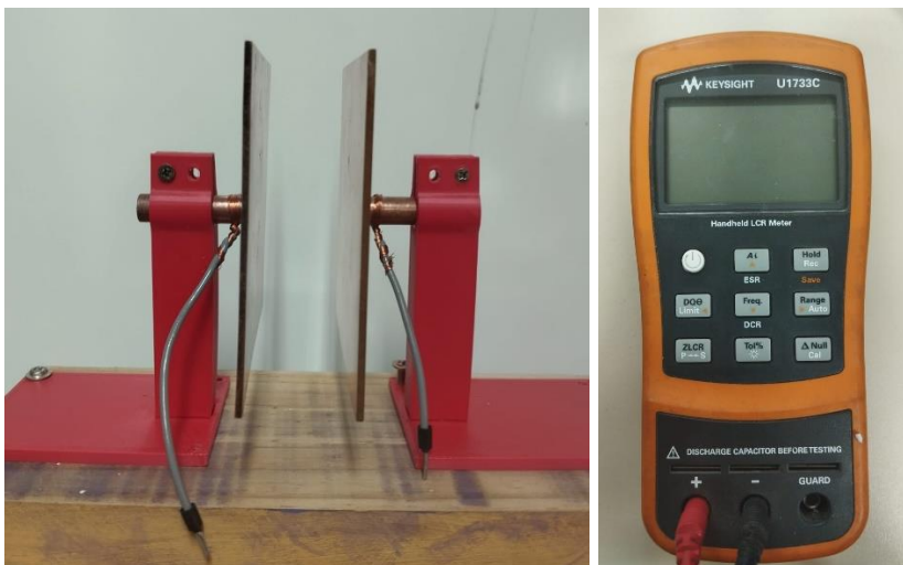
Figura 1- (a) Capacitor de placas paralelas e a estrutura de fixação. (b) Medidor LCR
