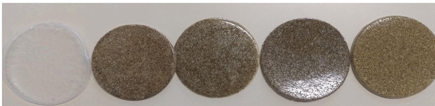
Figura 1- Filme de EPS reciclado puro e com fibra de gravatá.
