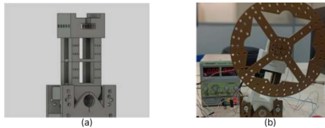
Figura 3. Estrutura do protótipo do pêndulo. (a) projeto da estrutura do pêndulo; (b) estrutura do pêndulo impresso em 3D.
