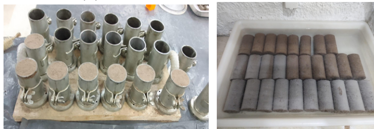
Figura 2 (a) - Corpos de prova- Grupo controle (0%), 10%, 25% e 50% e Figura 2 (b) - Cura saturada em cal
