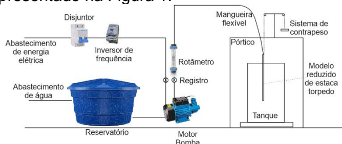
Figura 1: Desenho esquemático do aparato experimental para realização dos ensaios com modelo reduzido de estaca torpedo
