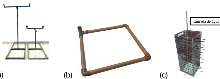
Figura 2: (a) Sistema de contrapeso; (b) Sistema de saturação por fluxo ascendente; e (c) sistema de saturação instalado no tanque.
