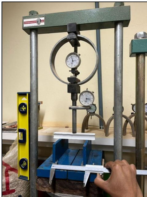
Figura 2: Anel Dinamométrico de 500kgf.
