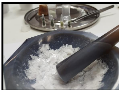
Figura 3: Seleção e moagem dos minerais (forsterita, muscovita, ortoclásio, enstatita) para a realização das misturas.
