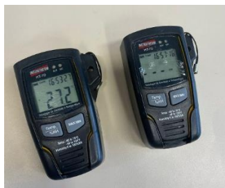
Figura 1: Dataloggers que foram utilizados para medição. Fonte: autora.
