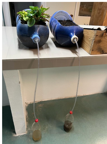
Figura 3: Experimento que possibilita visualizar a diferença escoamento superficial em um área com e sem vegetação. Fonte: Autores, 2023.
