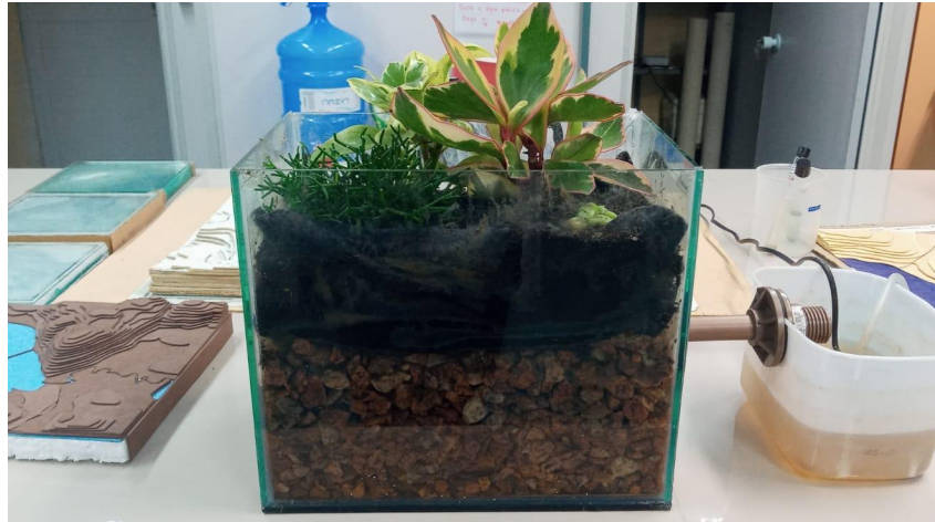
Figura 2: Modelo de trincheira de infiltração. Fonte: Autores, 2023.
