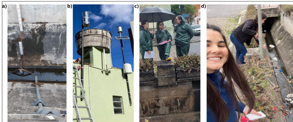
Figura 2 – a) Réguas linimétricas e sensor de nível instalados; b) Instalação do pluviômetro DNAEE, à esquerda, e do pluviômetro e estação hidrológica automática à direita; c) Medições de nível e limpeza durante evento; d) Limpeza pós evento.
