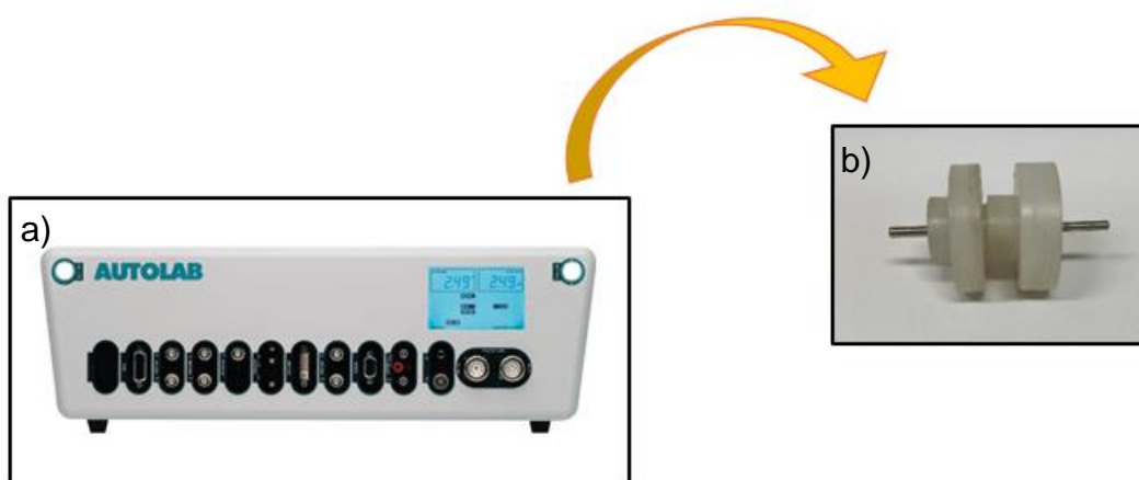
Figura 2: a) Potenciostato/galvanostato Autolab b) Célula eletrolítica para medidas em eletrólitos em gel.
