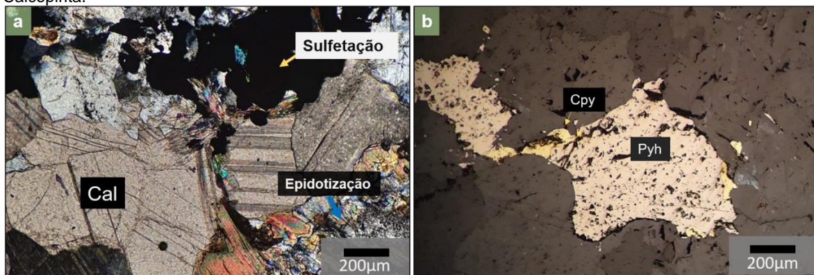
Figura 3 – Fotomicrografia da reação anfibolito-sienito-mármore. (a) Mineralogia de alteração associada a sulfetação; (b) Pirrotita (Pyh) e calcopirita (Cpy) sob luz refletida.
