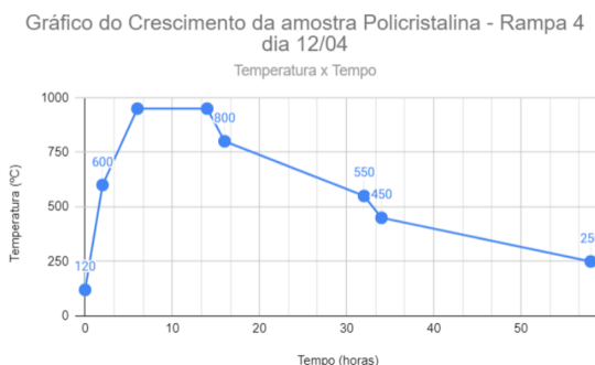
Figura 1: Rampa de crescimento da amostra Policristalina. Fonte : Autoral.
