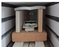
Figura 3: Configuração do forno para o monocristal 1. Fonte: Autoral.
