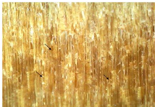
Figura 1. Representação da madeira da obra Alegoria, Sentido e Espírito da Revolução Farroupilha com detalhes aos raios (seta) e os traqueoides axiais em forma retangular vertical. (Plano long. radial 50x), fonte: Laboratório da Engenharia Madeireira
