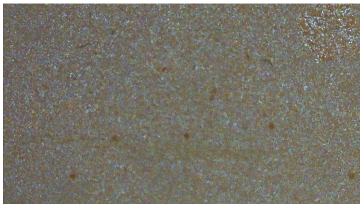
Figura 1 - Imagem de microscópio óptico do filme de \text{Cu}_2\text{O}
