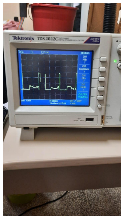
Figura 3: Osciloscópio com sinal do sensor já calibrado corretamente.
