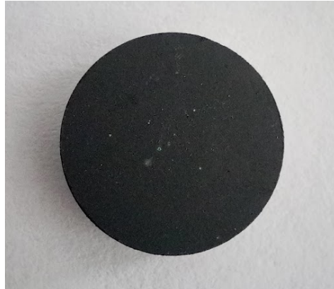
Figura 3 : Amostra supercondutora feita com pó comercial. Fonte: Autoral.
