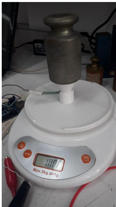
Figura 2: Sensor de força entre os dois suportes impressos sob medida sendo pressionado por uma massa de 1,0kg durante o processo de calibração.
