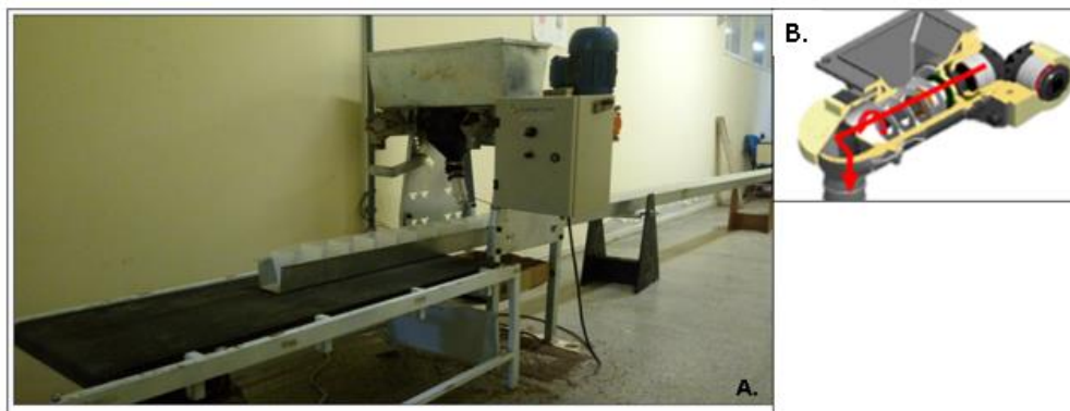
Figura 1. Bancada de testes de dosadores de fertilizante, abaixo esteira com calha(A), tipo helicoidal por transbordo transversal(B).
