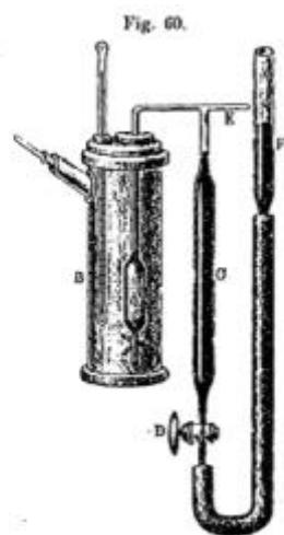
**Fig.1** Esquema da aparelhagem que Van't Hoff (1898) utilizou para estudar a marcha da reação de decomposição do gás arsina (*Études de Dynamique chimique* pag. 190, 1898).
