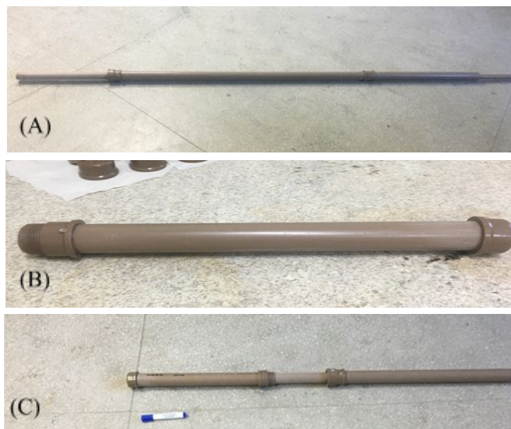
Figura 3 – (A) Amostrador por sucção de sedimento de fundo; (B) Tubo testemunhador; (C) Tubo testemunhador acoplado com o amostrador de sedimento de fundo.
