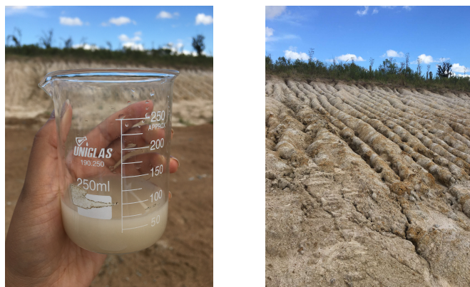
Figura 1. (a) Evidência do comportamento dispersivo testado em campo do solo da Figura b / (b) Ravinamento em solo dispersivo em Pelotas/RS.
