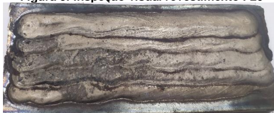
Figura 5: Inspeção visual revestimento F20
