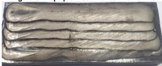
Figura 3: inspeção visual revestimento F10
