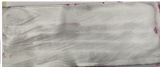
Figura 4: inspeção por liq. penetrante revestimento F10
