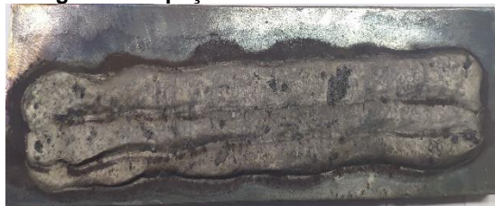
Figura 7: Inspeção visual revestimento F30
