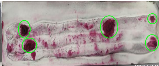
Figura 8: Inspeção por Liq. Penetrante Revestimento F30
