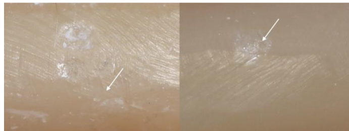
Figura 3: Aspecto da deterioração produzida pelo simulador Biocycle V2. Setas indicam área de dano por contato com o pistão.
