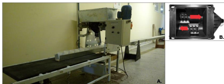
Figura 1. Bancada de testes de dosadores helicoidais de fertilizante, abaixo esteira com calha posicionada (A), tipo helicoidal duplo por transbordo longitudinal (B).
