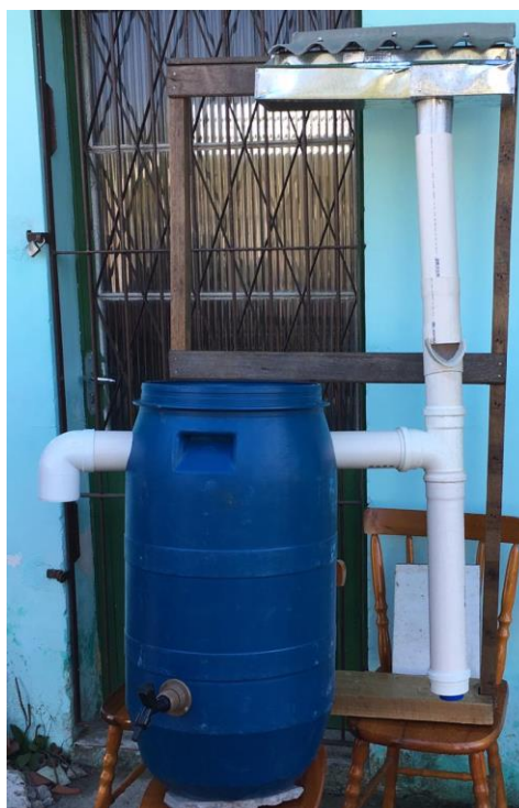
Figura 1 – Protótipo de minicisterna para reaproveitamento de água da chuva
