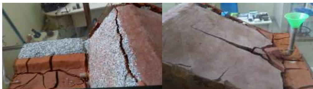
Figura 2: Rachaduras devido a ressecamento do barramento.
