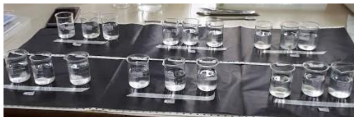
Figura 2. Fotografia do modelo experimental realizado para analisar o teor de intumescimento das amostras de xantana.
