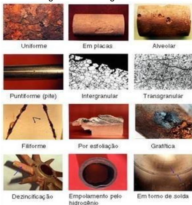
Figura 2: Morfologia da corrosão.
