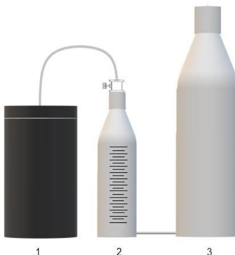
Figura 1. Biodigestor conectado ao medidor de biogás.
