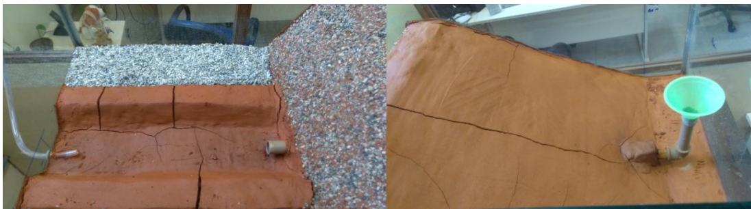
Figura 1 - Protótipo de barragem de terra construída pelo grupo, com rachaduras devido ao secamento do solo.
