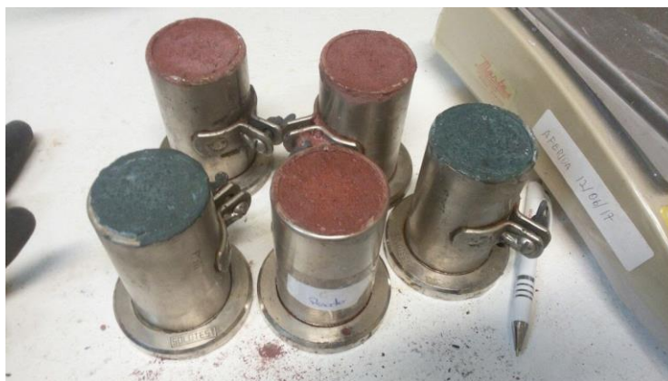
Figura 1 – Produção de corpos de prova de argamassa coloridas
