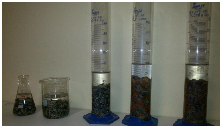
Figura 3 – Caracterização dos agregados para produção de concreto
