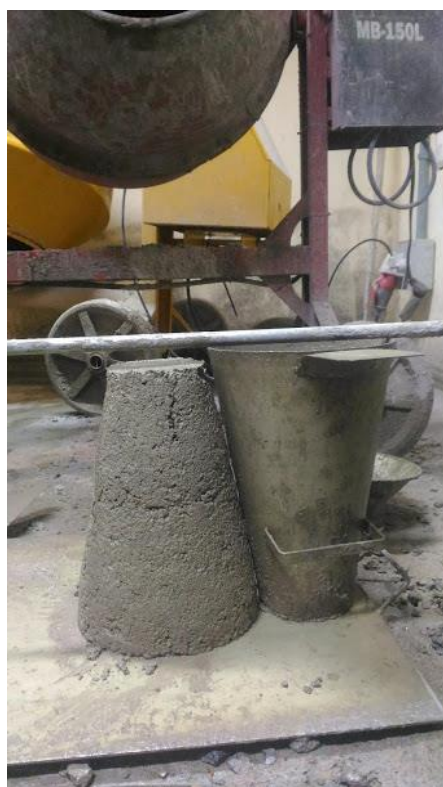
Figura 2 – Determinação da consistência do concreto pelo abatimento do tronco
