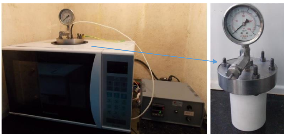
Figura 2.1 – Micro-ondas adaptado HSM e célula reacional, respectivamente.
