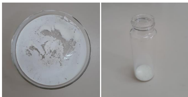
Figura 2.2 – Amostra após secagem em estufa e pó de \text{KNbO}_3 obtido após raspagem (respectivamente).
