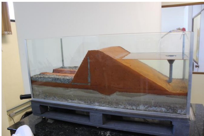
Figura 1: Protótipo de uma Barragem de Terra.
