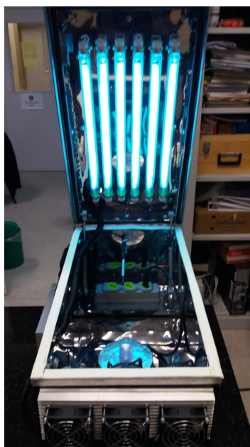
Figura 1 – Interior da caixa fotocatalítica
